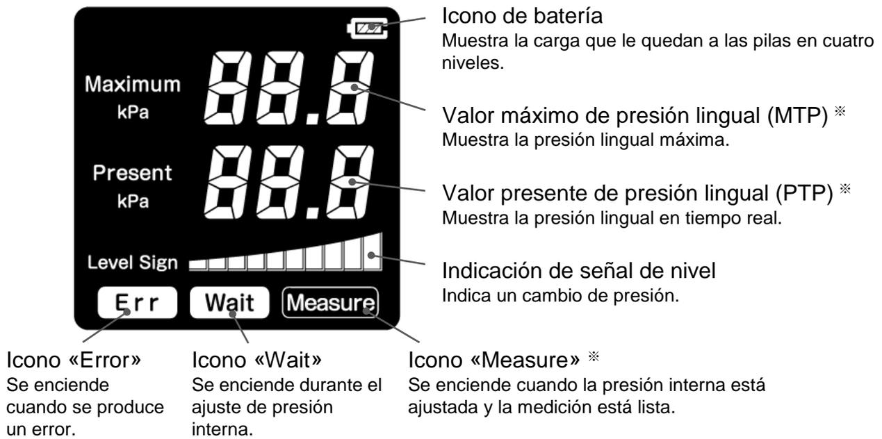
※ Si se detecta un valor de presión de 80 kPa o más, la visualización parpadea porque el valor de presión está fuera del rango de precisión de medición.
