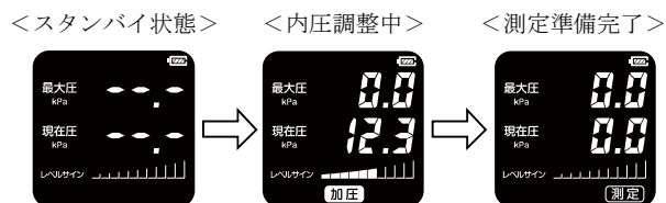
図2. デジタル舌圧計の測定/リセットボタンを押した後の内圧調整中及び測定準備完了の表示
